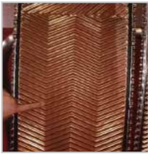
導電率 0.5 μS以下純水での鉄分析出、腐食
