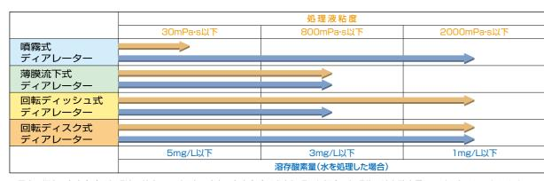
\*図中の橙色の矢印(→)は処理液の粘度のレベルを、青色の矢印(→)は水を処理した場合の処理後の溶存酸素量のレベルを示しております。 また、噴霧式ディアレーターでは固形物を含む処理液を処理できません。
