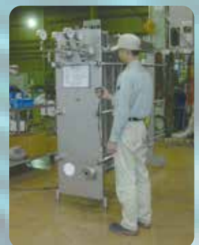
気密テスト 完成検査
