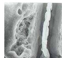
応力腐食断面組織
