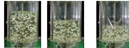
変量攪拌の様子 (左から液量100%、80%、60%、液深/槽内径=1.0=100%)
