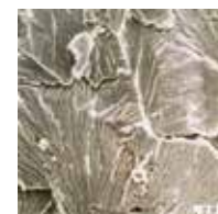
粒界腐食断面組織
