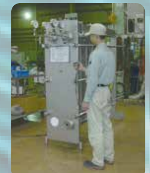
気密テスト 完成検査
