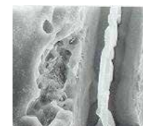
応力腐食断面組織
