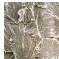
粒界腐食断面組織
