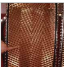
導電率 0.5 μS以下純水での鉄析出、腐食
