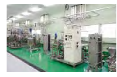
多機能抽出テスト装置 コーヒー、お茶から出汁まで 高品質液の抽出可能
