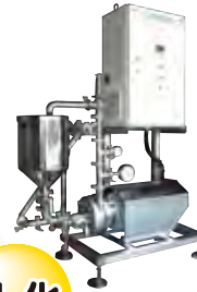
多機能抽出テスト装置 コーヒー、お茶から出汁まで 高品質液の抽出可能
