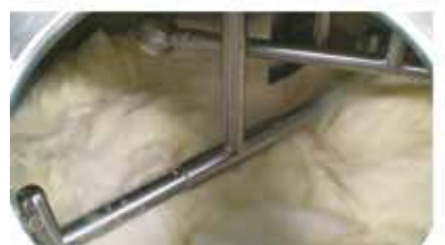
大きなブロックがなくなった後 Scraper 起動開始
