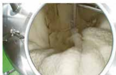
Dynamixer Processor 運転開始180s Scraper 起動
