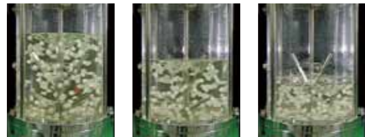
変量攪拌の様子 (左から液量100%、80%、60%、液深/槽内径=1.0=100%)
